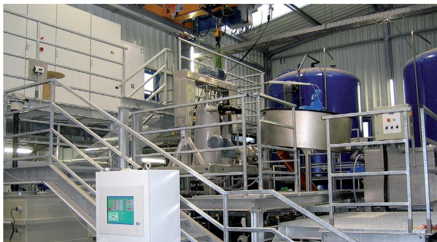
Deponiesickerwasserreinigung mit einem Floformer 2L
